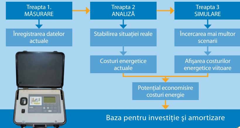
EBS Sistem de bilanțare energetică
